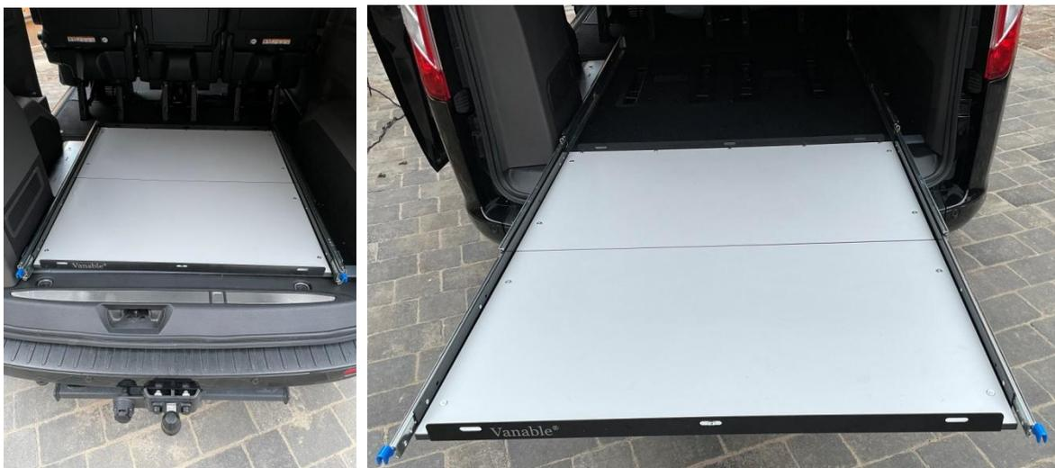
Den Auszug im ausgezogenem Zustand nur mit maximal 180kg über die Fläche verteilt beladen.
