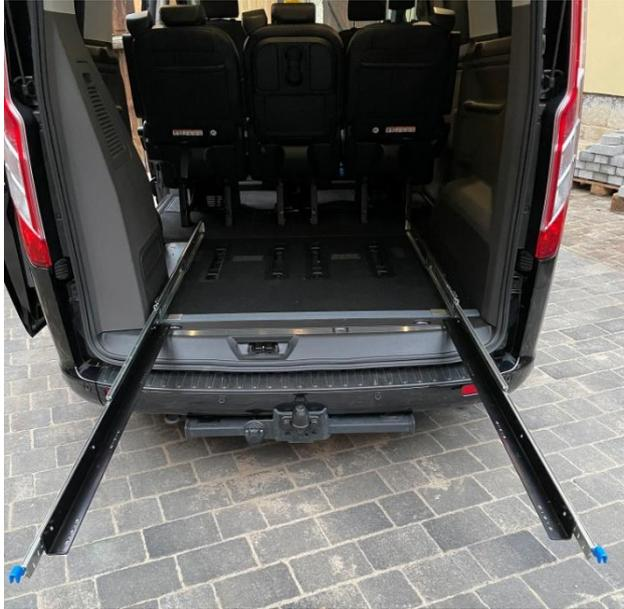
PVC-Unterlage unter den vorderen Winkel legen, damit wird bei Belastung ein Zerkratzen der hinteren Fahrzeugblende vermieden.
