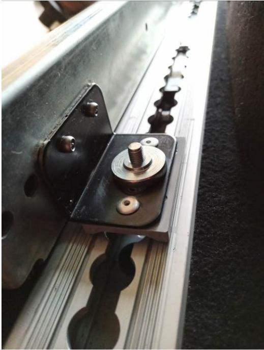
Diesen Vorgang auf der anderen Seite wiederholen und erst dann alle vier Fixierungsmuttern handfest anziehen. Die Kontermutter aufsetzen und anschließend handfest anziehen.
