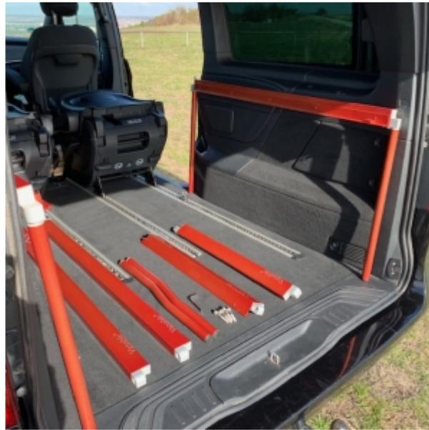
Dazu einfach hinten und vorn ein Bein unterstellen und die Verzurrösen unterlegen. Lehnt die Seitenteile am Fahrzeug an. Das der Schiebetür zugewandte Bettbein heftet ihr mit einer Schraube an. Die geschwungenen Beine gehören an die Schiebetür.
