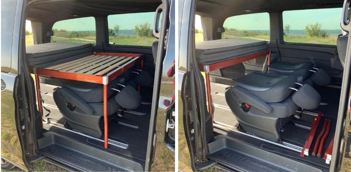
In nur wenigen Schritten kannst Du die vordere Sitzreihe nun wieder nutzbar machen. Dazu einfach die Matratze nach hinten klappen, den Lattenrost zusammen schieben und die vorderen 4 Schrauben lösen. Seitenteile und Bettende demontieren und das Bettende letztendlich in der Mitte wieder aufsetzen und verschrauben.
