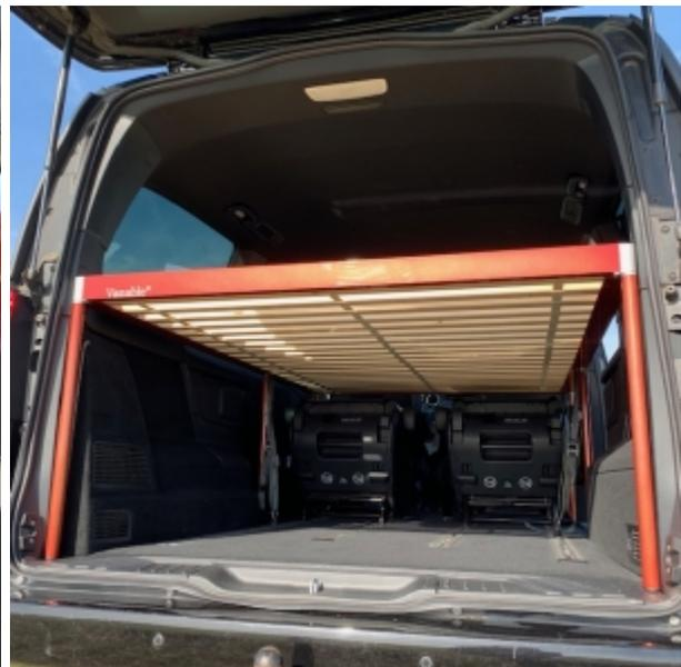
Der Rahmen steht! Der beste Zeitpunkt das Vanable am Fahrzeug über die Verzurrpunkte zu verzurren. I.d.R. reicht das an zwei Punkten aus. Danach legt den Lattenrost auf den Rahmen und rollt ihn aus. Legt die jeweils letzten Latten hinter die Arretierungen.
