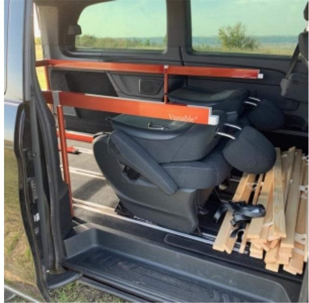
Nun werden die vorderen Seitenteile auf die Hinteren aufgesetzt und verschraubt. Die freien Enden einfach ein wenig anheben, so lassen sich die Schrauben leicht eindrehen. Achtet auch hier auf die Ausrichtung der Verzurrösen.
