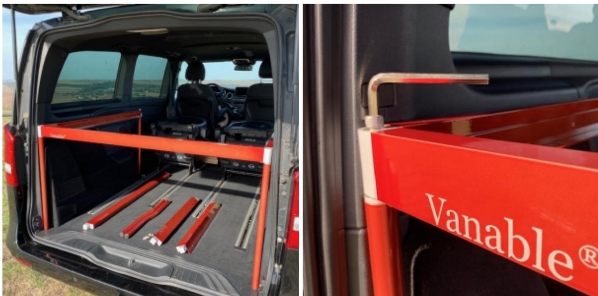
Weiter geht es mit dem hinteren Kopfteil. Legt es dazu zunächst auf einem Seitenteil auf und sichert es mit einer Schraube. Dann legt ihr es auf der anderen Seite auf und zieht beide Schrauben gut an. Sind beide Seitenteile richtig aufgestellt, lassen sich die Schrauben leichtgängig eindrehen. Achtet darauf, dass die Verzurrösen in Richtung Verzurrpunkte des Fahrzeugs ausgerichtet sind. Sie sollten nicht nach außen zeigen, da sie so die Verkleidung des Fahrzeugs zerkratzen können.
