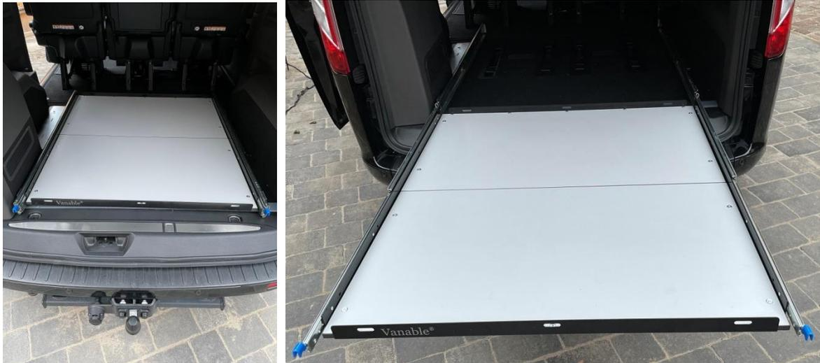
Den Auszug im ausgezogenen Zustand nur mit maximal 180kg über die Fläche verteilt beladen.
