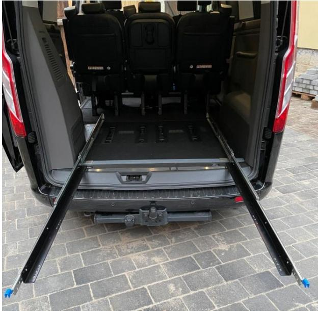
PVC-Unterlage unter den Winkel nahe Heckklappe legen, damit wird bei Belastung ein Zerkratzen der hinteren Fahrzeugblende vermieden.
