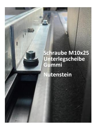
Beide Schienen auf gleicher Höhe fixieren, so dass die Heckklappe ohne Kontakt geschlossen werden kann.
