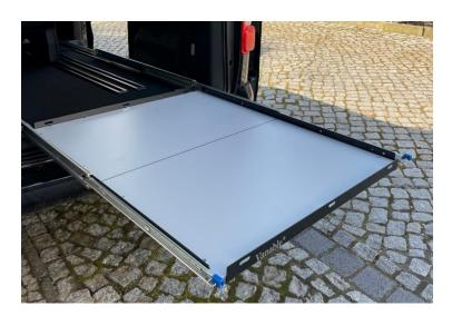
Nach Montage der Bretter darauf achten, dass beide Seiten der Slides auf gleicher Höhe liegen und dass die Heckklappe kontaktlos schließt. Anschließend die Slides in den Bodenschienen fest anschrauben, bis der Gummi auf 1/3 – 1/2 seiner ursprünglichen Größe zusammengedrückt ist.
